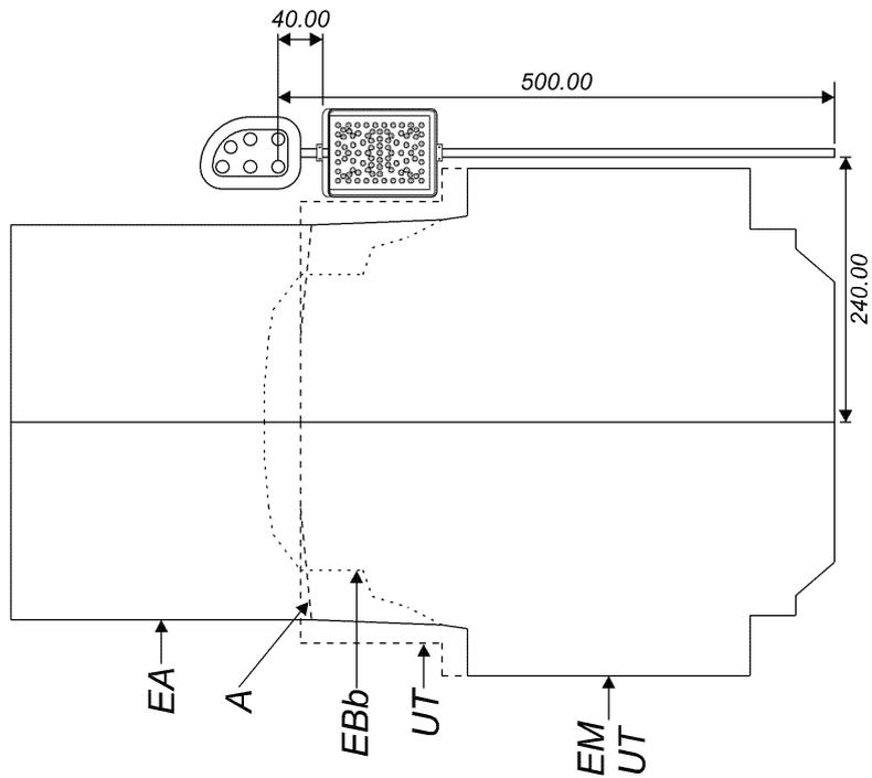
x) = Højdebegrænsning på A-profil (ikke el-strækninger). Profilet er iøvrigt identisk med EA-profilet.
