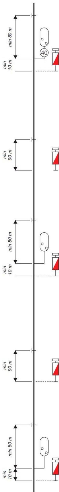
Tilslutningen til den særlige stopisolation (se forklaringen i afsnit 0 om S-baner) placeres min. 10 m efter HKT-standsningmærket, og min. 80 m foran stødet.
