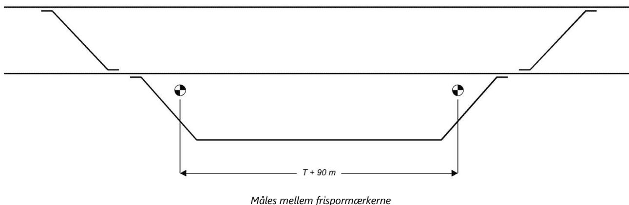
**Fig. 5 Flere spor, midtliggende overhalingsspor**
