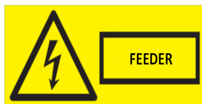
Figur 4.1.8.2-1b Advarselstavle for AT-fødeledning.
