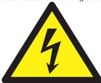
Figur 0-1 Advarselsskilt mod farlig elektrisk spænding ifølge Arbejdstilsynets bekendtgørelse 624 af 4. maj 2015 [8].
