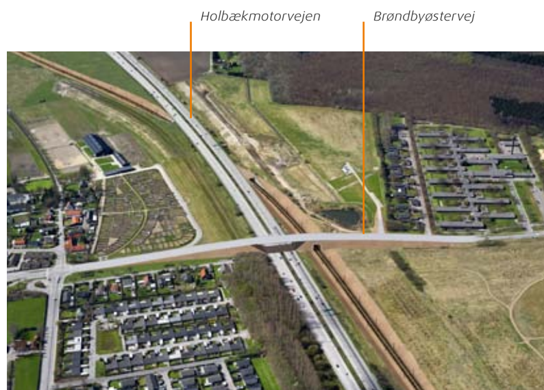
Den nye bane passerer under Brøndbyøstervej, der føres over både banen og Holbækmotorvejen på en ny bro. Herefter drejer banen i en lang tunnel under Holbækmotorvejen.
