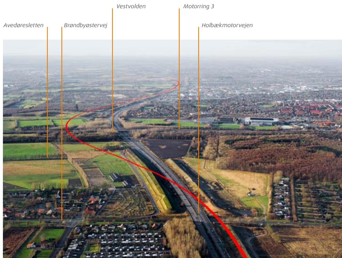
Efter Brøndbyøstervej krydser den nye bane under Holbækmotorvejen og følger herefter sydsiden af motorvejen.
