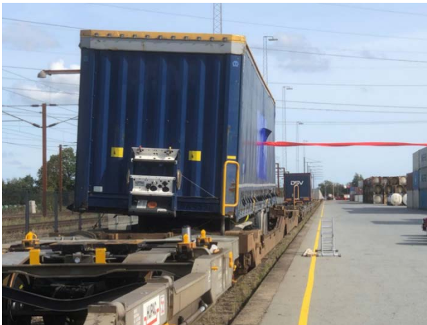
Figur 14 Trækforsøg af trailer på lommevogn.
