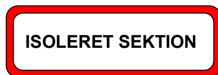
Figur Bilag 10.3-1. Skiltning ved isolerede sektioner. Skiltets størrelse skal være 300 x 100 mm. Kanten skal være 15 mm. Skiltet skal udføres med refleks.
