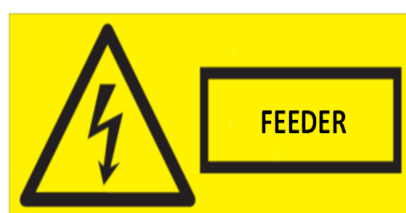
Figur 4.1.8.2-1b Advarselstavle for AT-fødeledning.
