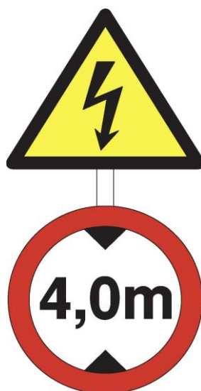
Figur 10.6.2-2 Skilt for niveauoverskæring, der skal anvendes, når man ikke skal anvende skiltet i figur 10.6.2-1.
