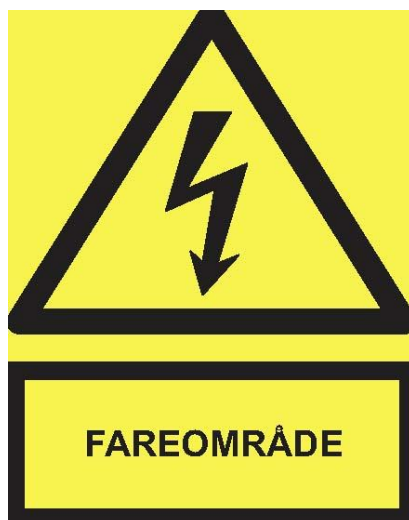
Figur 11.1.8.2-3 Advarselstavle for farligt elektrisk område.
