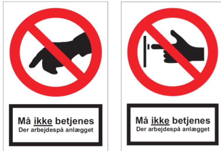
Figur bilag 10-3 Forbudsskilt "Må ikke betjenes": På bagsiden skal noteres dato, navn samt telefonnummer på den person, der foretager spærringen.
