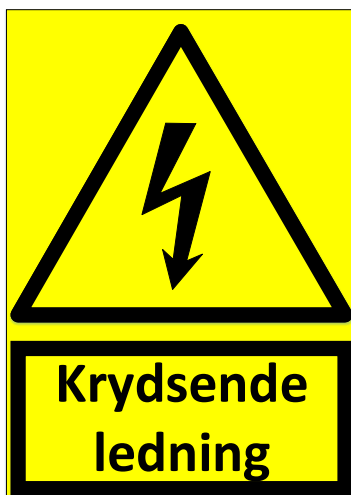
Figur 11.1.8.2-5. Advarselstavle for krydsende ledning.
