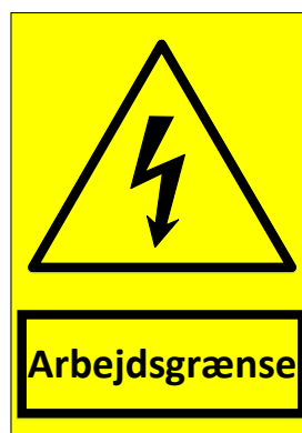
Figur 11.1.8.1-1 Advarselstavle til opsætning i mast.
