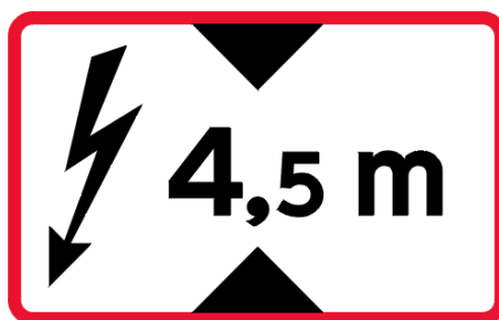
Figur 10.6.2-1 Skilt for niveauoverskæring, der skal anvendes, når der skiltes mod offentlig vej (skiltet er påkrævet i færdselsloven som UA73)
