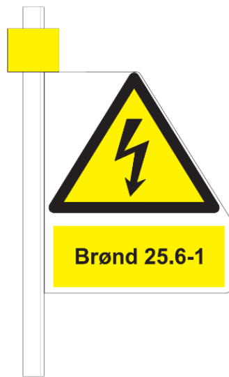
Figur 10.12.11-1 Skilt ved kabelbrønd på stolpe.
