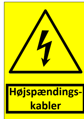
Figur 10.12.11-2 Skilt ved kabelbrønd på kabelbrønd.
