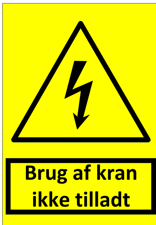
Figur 10.11.2-3 Brug af kran ikke tilladt. Skiltet benyttes på områder, hvor maskiner og større redskaber kan komme i farlig nærhed af køreledningsanlægget.
