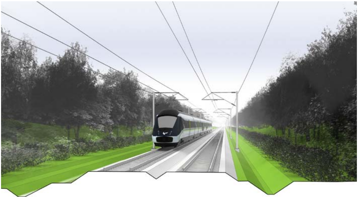
Typisk tværsnit af strækningen, hvor der udvides fra et til to spor og elektrificeres. Dæmningens geometri ændres.
