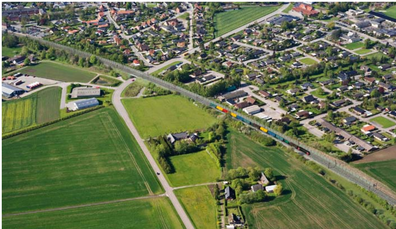
I Grundløsning 2 etableres ny linjeføring nord for Glumsø. I nederste højre hjørne af visualiseringen ses det flyttede spor.
